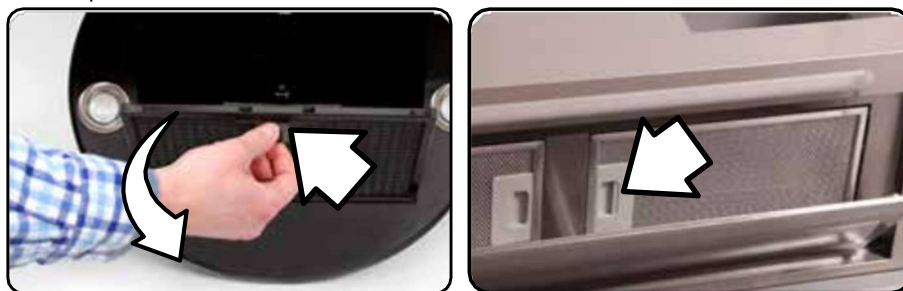
Obr. 8. Demontáž hliníkového tukového filtru
