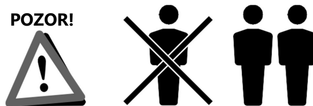
Obr. 7. Poznámka: k montáži jsou zapotřebí min. 2 osoby.
